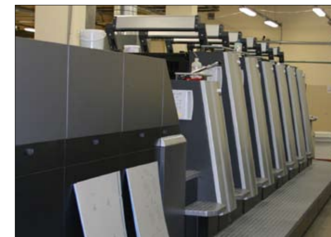
Новая печатная машина Speedmaster XL 75-6+L, подготовленная для печати УФ-красками и лаками на производстве «ПРОМИС»
